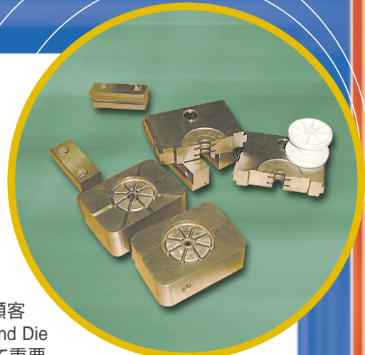
Apex社は、SLSシステムを使って制作した鋳型で20,000個以上の部品を鋳造できる。
