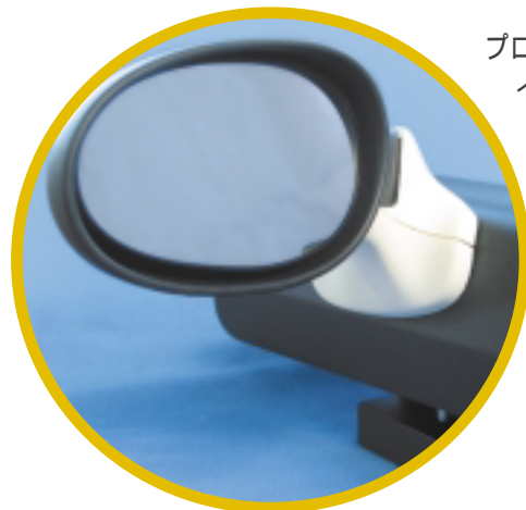
ミラー部位の装着のためのレーザー焼結部品を持つドア柱の模型
