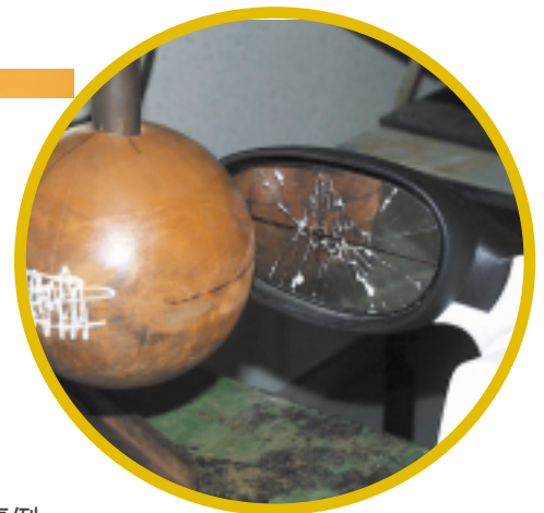
揺れ衝撃の耐性検査: 衝突した時、ミラーは適切に折れ曲がるか?
